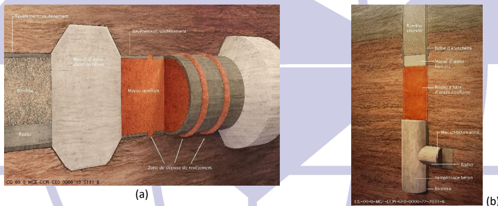
Figure 1 Exemples de scellements de galerie (a) et de puits (b)
