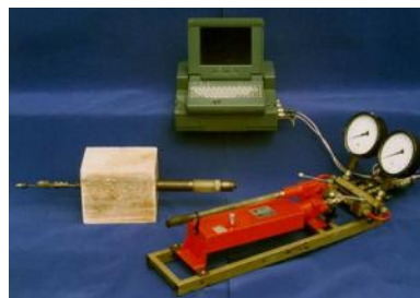
Equipement pour fracturation hydraulique
