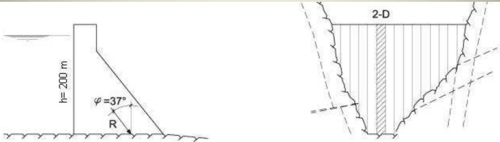
$\varphi$  = angle de friction admis de  $37^\circ$  en faisant référence à la limite de USACE
