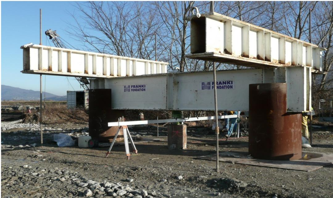
Figure 3. Dispositif essai de chargement statique
