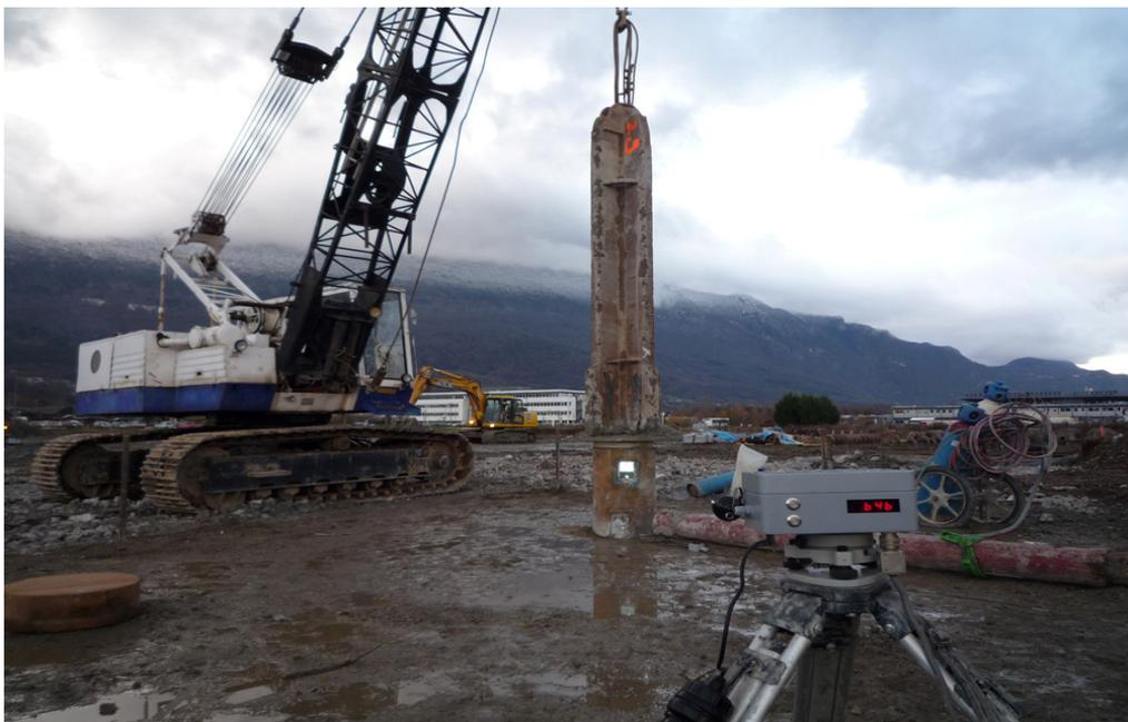
Figure 2. Essai de chargement dynamique avec théodolite SIMBAT
