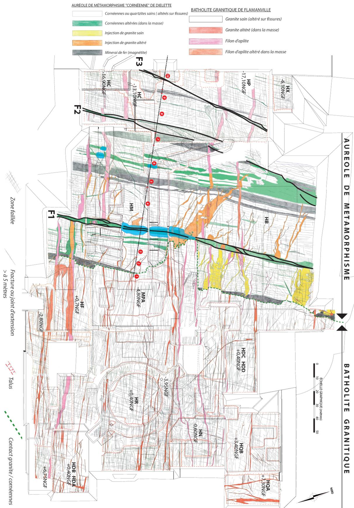
Figure 1 : Levé géologique des fonds de fouilles de la tranche EPR de Flamanville. La numérotation dans la série métamorphique correspond à la numérotation du tableau 2.
