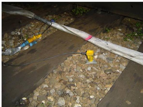
Figure 3 : Un géophone posé sur ballast
