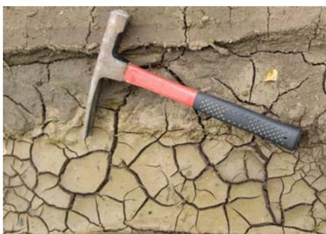
Figure 1 – Fissures de retrait à la surface d'un sol argileux
