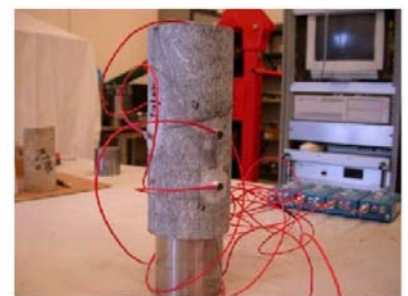
Figure 4. Essais acoustiques en laboratoire, Système d'acquisition
