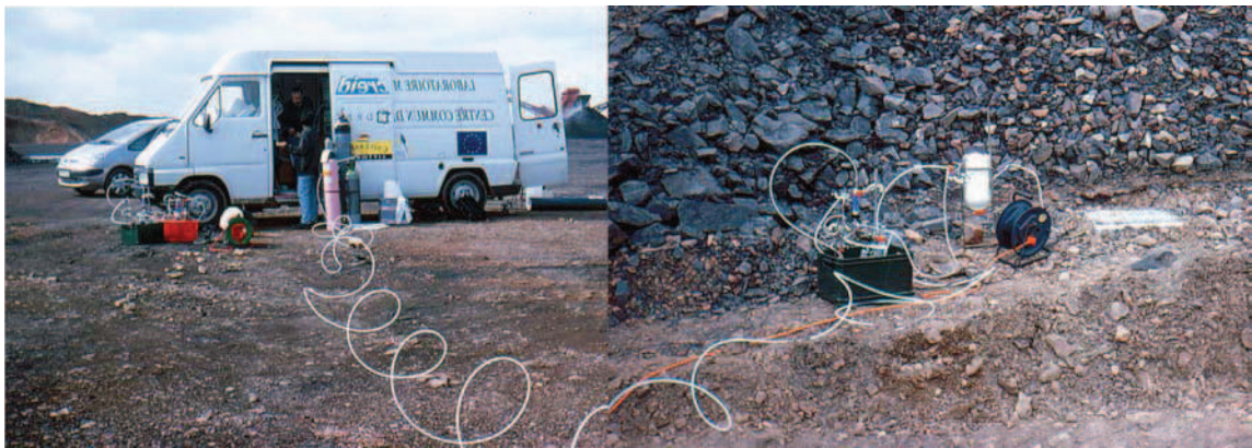
Figure7. Dispositif de piégeage et de mesure des émissions de gaz et installation dans une zone active du terril n°76, 2002.
