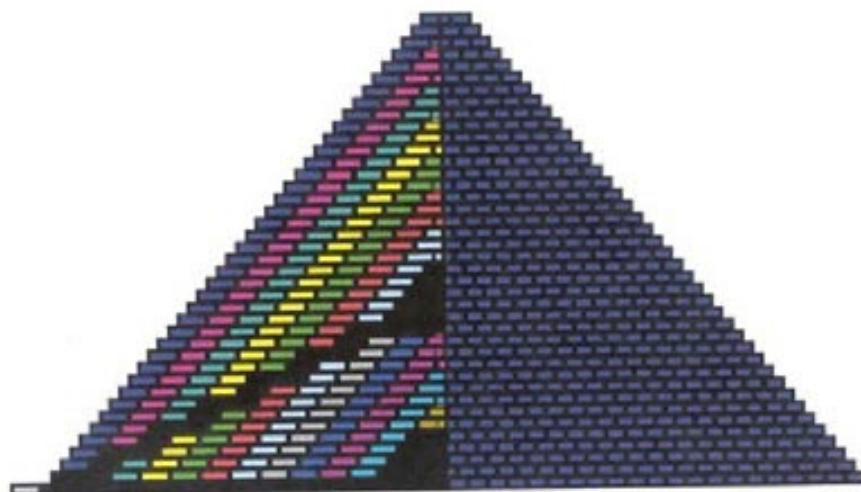
Figure 11 : Schéma montrant comment, par omission de certains blocs, on obtient la pente de la grande galerie corollairement à celui de la pyramide ( image de simulation informatique ).
