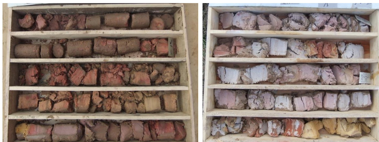
Figure 7 : Résultats des carottages au sein des grès tendres
