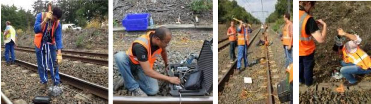
Figure 5. Campagne d'essais réalisés, sondages : a) pénétrométriques Panda 3®, b) géoendoscopiques, c) MASW et d) plaque dynamique sur la ligne Aubrais - Orléans.
