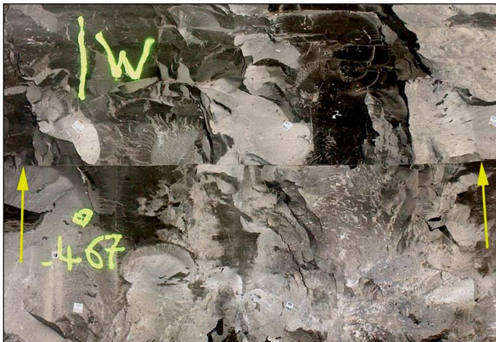
Fracture hydraulique horizontale à 467 m
