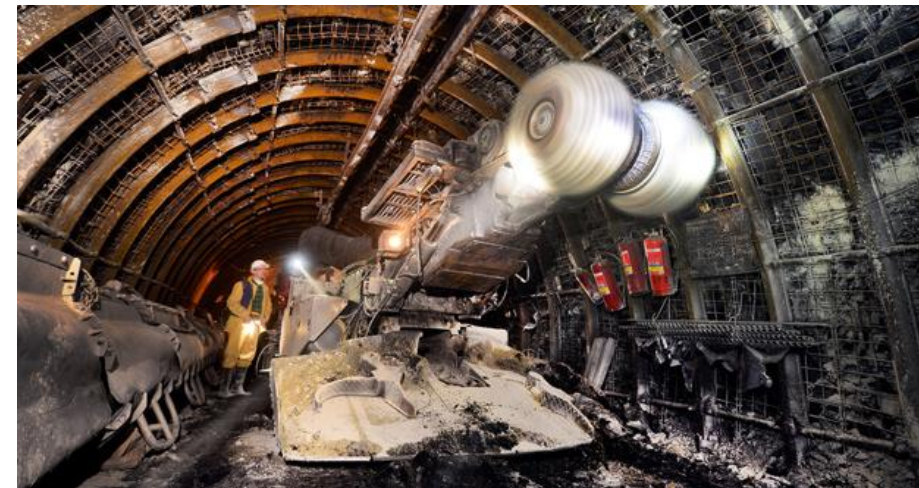
Soutènement d'une galerie profonde (charbon)
