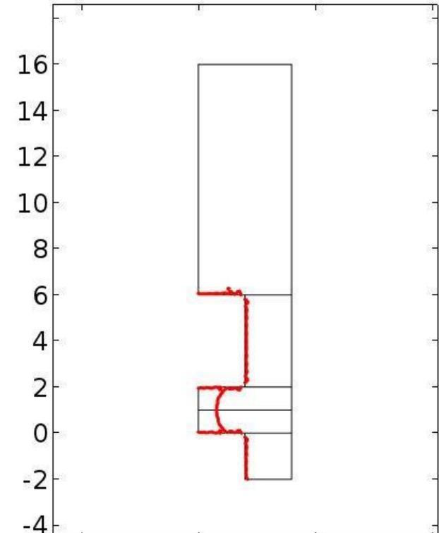
Un autre facteur aggravant est la mauvaise superposition des piliers des différents niveaux: **risque de rupture induit par le poinçonnement / cisaillement**
