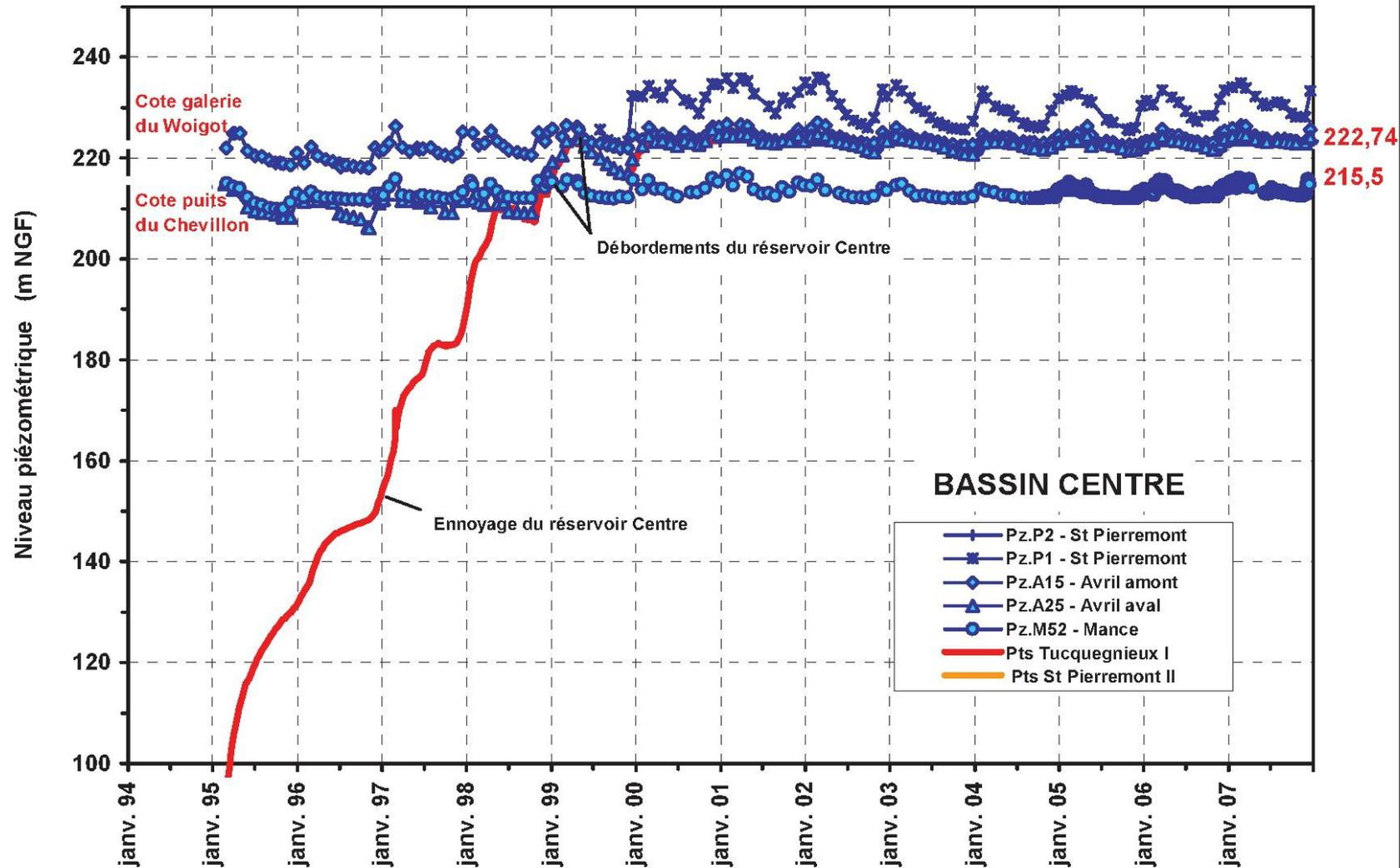
Remontée du niveau de la nappe d'eau dans le bassin ferrifère Centre (rapport BRGM, Thonnon et al, 2010).
